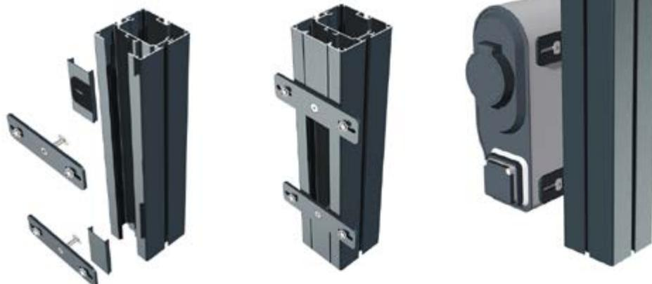
Fixation par 2 boulons M6 avec un écartement compris entre 130mm et 200mm
