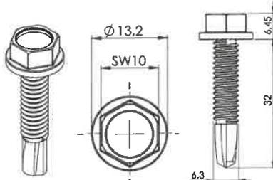
Vis sert à assurer la mise à la terre du déflecteur latéral (pas de fonction mécanique) et/ou les déflecteurs (ou pare-vents) latéraux
