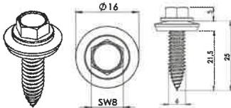
Vis sert à assurer le maintien du porte-ballast périmétrique du champ (il n'a pas de fonction mécanique) – visée par ETA n°13/0178 du DiBt
