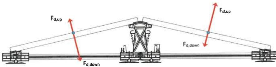
Les composantes horizontales des forces perpendiculaires (F) sont utilisées pour la détermination de la résistance au glissement du système.
