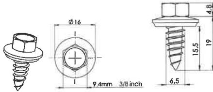
Vis sert à assurer le maintien et la mise à la terre du déflecteur arrière (pas de fonction mécanique) – visée par ETA n°13/0178 du DiBt
