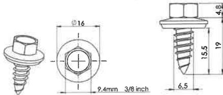
Vis sert à assurer le maintien et la mise à la terre du déflecteur arrière (pas de fonction mécanique)
