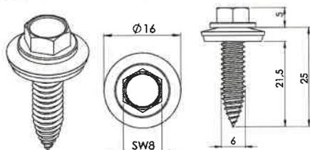
Vis sert à assurer le maintien du porte-ballast périmétrique du champ (il n'a pas de fonction mécanique)
