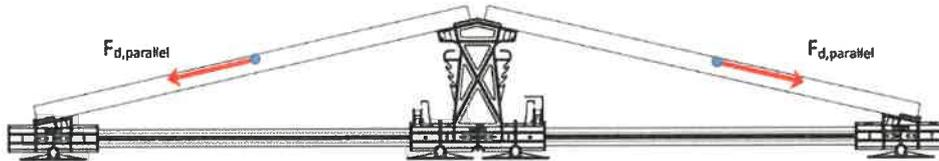
Les composantes horizontales des forces parallèles (F) sont utilisées pour la détermination de la résistance au glissement du système.
