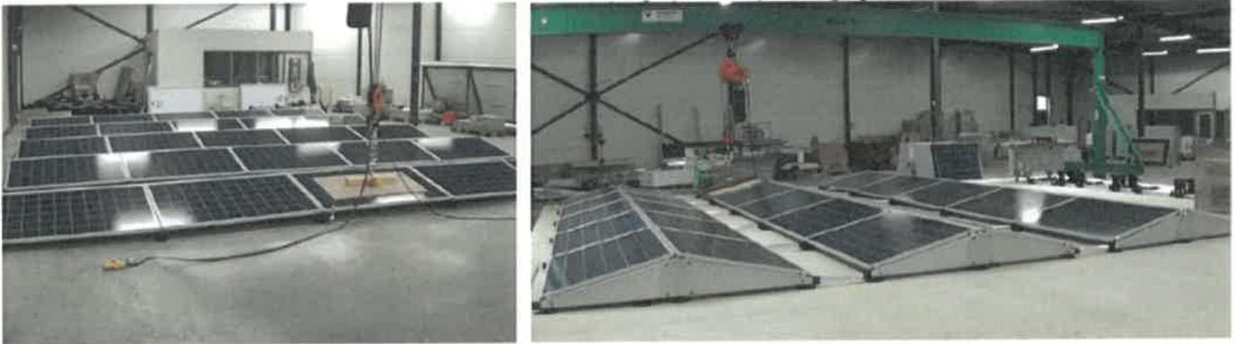
Les mesures de la charge du vent ont été effectuées et élaborées conformément à la recommandation CUR C103 « Études en soufflerie des charges de vent sur les bâtiments (de grande hauteur) » et au projet de norme EN 7250: 2014 « systèmes Énergie solaire - intégration dans les toitures et façades - aspects du bâtiment ».
