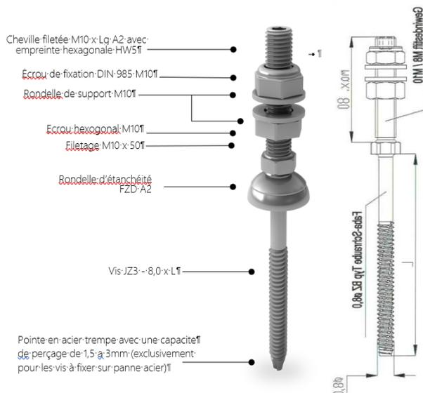
La vis de fixation panneaux solaires est disponible en différentes longueurs et différents diamètres. Elle est adaptée pour les toitures en fibrociment à profil ondulé et ossature porteuse en acier (S235). L'étanchéité de la couverture est assurée, selon la vis utilisée, soit par un joint FZD (références 2003013 à 2003017), soit par une calotte E16 (références 2003018 à 2003021).
