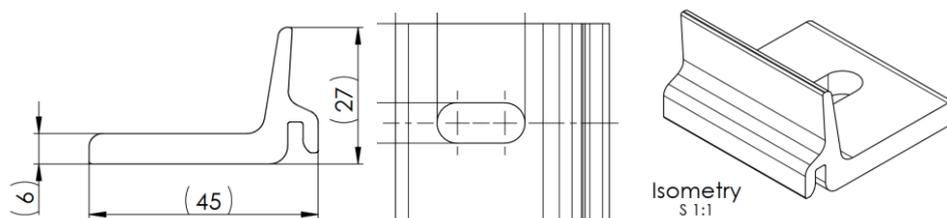
La modification du climber n'a pas de conséquence sur la capacité résistante du kit de fixation.
